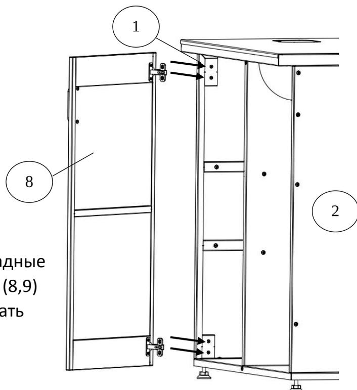
❗ Установить на дверцы (8,9) ручки и накладные петли из комплекта. Прикрепить дверцы (8,9) к боковым стойкам (1) и (2), отрегулировать петли.
