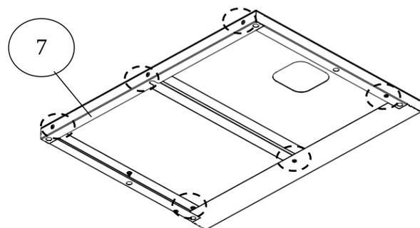
❗ Прикрепить раму столешницы (7) к стойкам (1), (2), (4) снизу изнутри.
