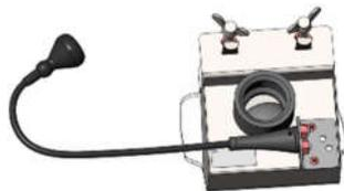
Подкладку (6) использовать для крепления ВМУ к тонким столешницам, толщиной менее 20 мм.
