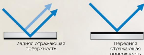
Для повышения отражательной способности стоматологических зеркал была разработана специальная инновационная технология нанесения покрытия на внешнюю, верхнюю поверхность стекла HR Front. Покрытие HR Front однократно отражает свет, что позволяет избежать паразитных бликов и диффузии светового потока в толще стекла. Таким образом, коэффициент отражения повышается до 98%! Внутриротовые зеркала HR Front обеспечивают высокую четкость и яркость изображения, и превосходную точность цветопередачи.
