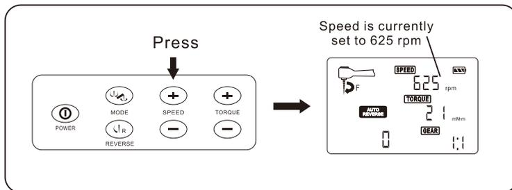
4. You can adjust torque: press "TORQUE+" or "TORQUE-" , the torque range: 3、6、9、12、15、18、21、25、30、35、40、45、52 mN.m ;
