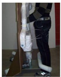
Зафиксуриуйте стойку с помощью 4 шайб UNI8842 и 4 болтов UNI5931 M8x16.
