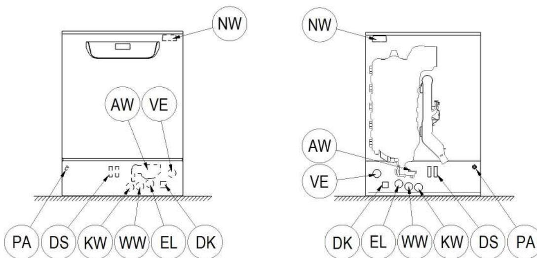
KW Подключение холодной воды
