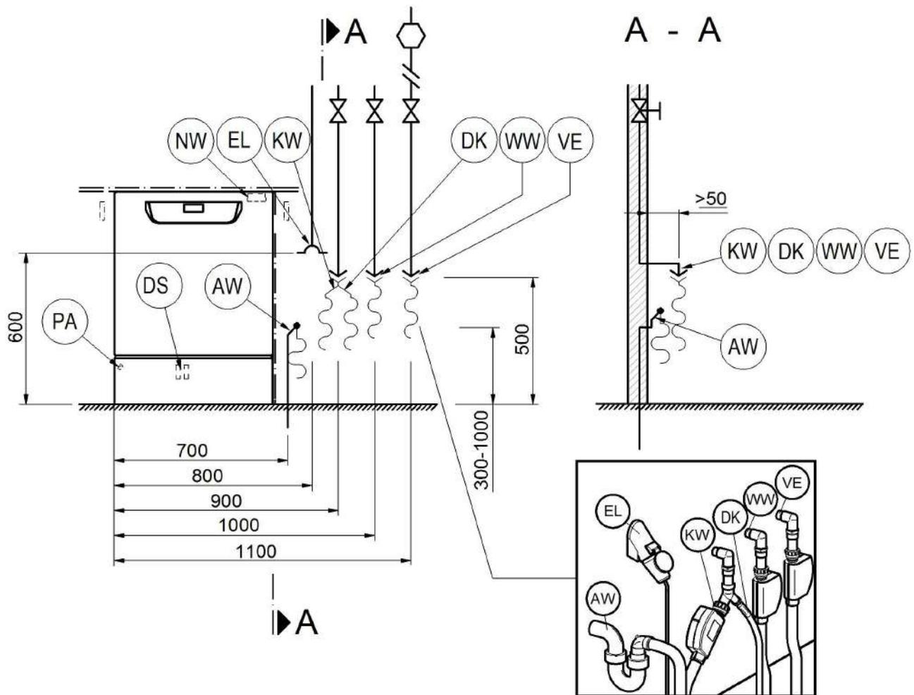
KW Подключение холодной воды
