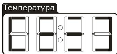
На индикаторе «Программа/Параметр» отображается значение выбранного параметра. Если в течение 5 секунд не будет повторного нажатия одной из указанных выше кнопок, то электропечь перейдет в режим индикации выполнения программы.
