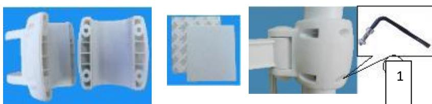
2. Соедините кронштейн и установочную плиту с помощью болтов №2, болты могут быть плотно затянуты. Используйте тот же номер болтов для закрепления держателя камеры. (Внимание:держатель камеры крепится в зависимости от размера дисплея).
