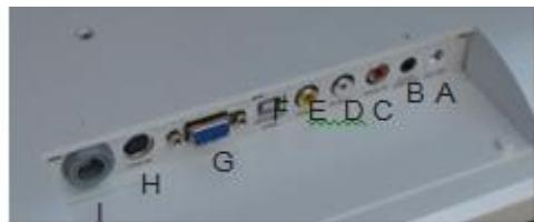
А: Постоянный ток 12V входная мощность 3A
