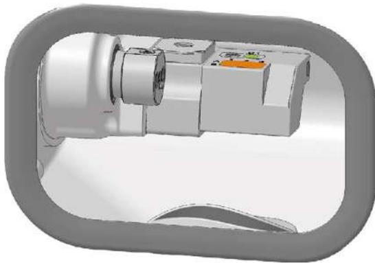
FIG. 59 TOOL MAGAZINE (MARKED ORANGE)
