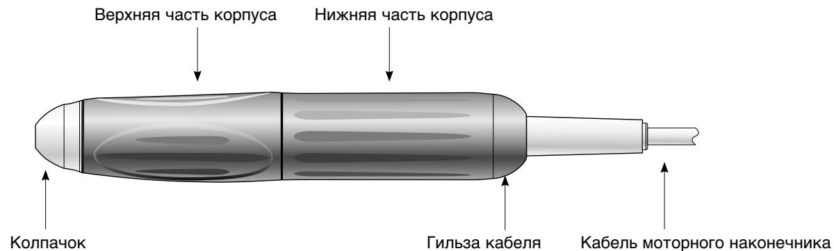
**Электрический мотор »Е-типа« LA-3E**
